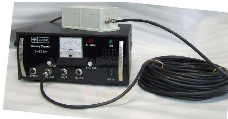
تغذیه دستگاه از برق 220 ولت بوده و لتاژ خروجی AC است که مناسب برای عایقهای مرطوب و خطوط تولید و پوشش لوله های عایق بندی شده می باشد ، پروب (عصا ) توسط کابل بلند به دستگاه ارتباط دارد و از روی دسته میتوان از راه دور دستگاه را روشن و خاموش نمود. دارای خروجی میباشد ( external Alarm )
