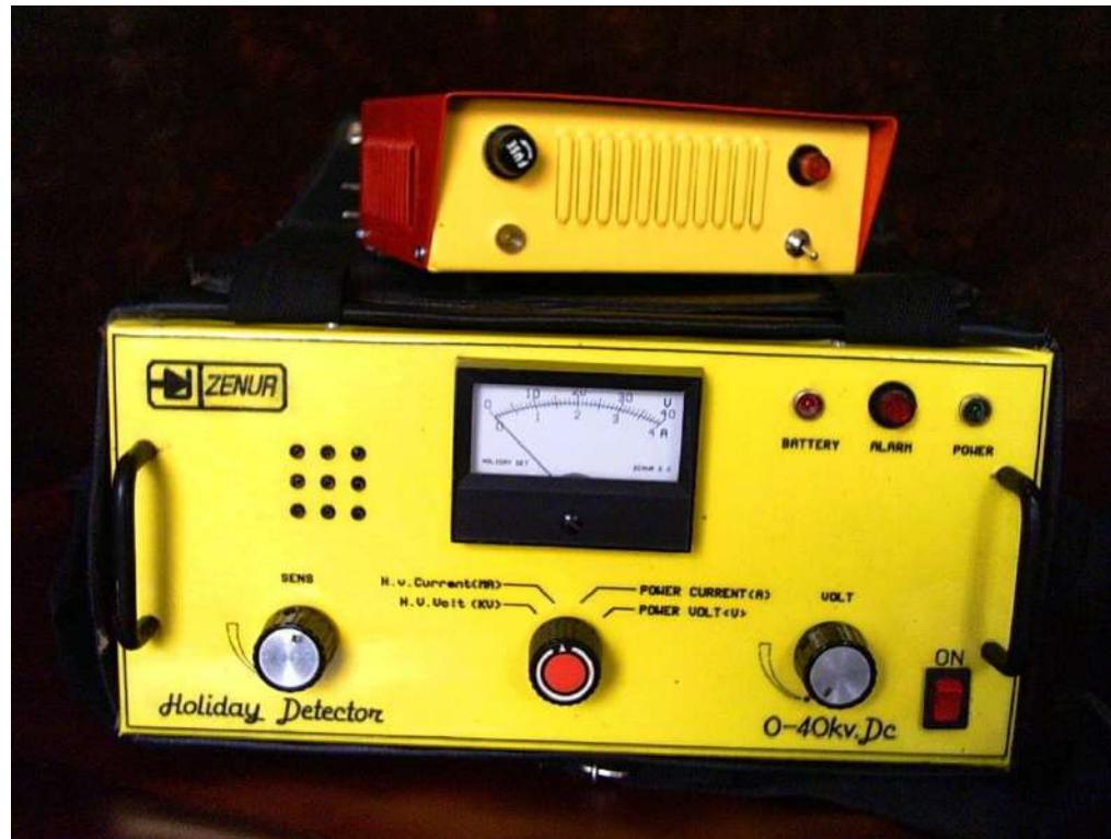
دستگاه هالیدی 40 کیلوولت با امکان نشاندادن مقدار جریان ( H.V. های ولتاژ ) خروجی ، قابل حمل همراه با شارژور
