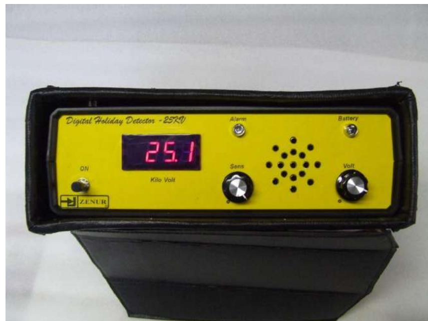
دستگاه های 25 کیلو ولت در ابعاد معمولی تولید میگردند ، دقّت و لتاژ خروجی در دستگاههای دیجیتالی 0.1 کیلو ولت میباشد
