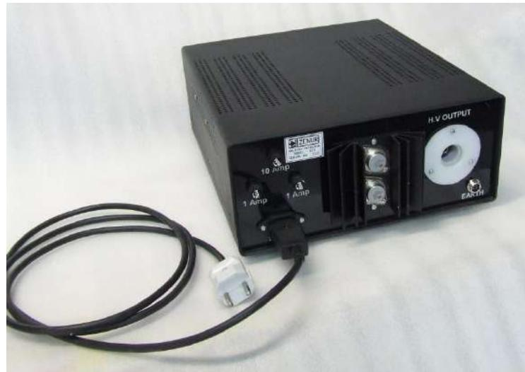
نمای پشت دستگاه تست عایق سیم و کابل
