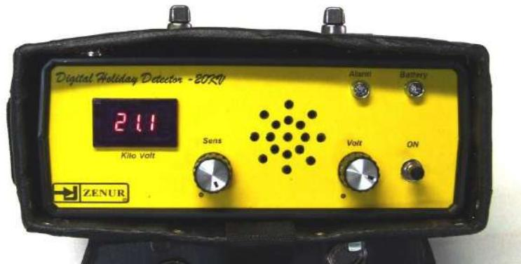
این دستگاهها در ابعاد متوسط تولید می‌گردند ، ولتاژ خروجی تا 20 کیلو ولت می‌باشد . دقّت نمایش ولتاژ خروجی در دستگاههای دیجیتالی 0.1 کیلو ولت می‌باشد
