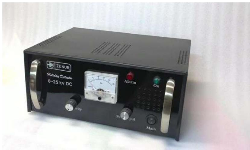
تغذیه دستگاه از برق 220 ولت بوده و لتاژ خروجی دی سی است که مناسب برای عایقهای خشک میباشد ، پروب (عصا) توسط کابل بلند به دستگاه ارتباط دارد و از روی دسته میتوان از راه دور دستگاه را روشن و خاموش نمود. دارای خروجی ( external Alarm ) میباشد
