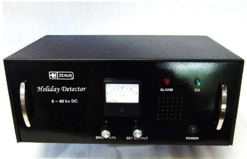
تغذیه دستگاه از برق 220 ولت بوده و لتاژ خروجی دی سی است که مناسب برای عایقهای خشک میباشد ، پروب (عصا) توسط کابل بلند به دستگاه ارتباط دارد و از روی دسته میتوان از راه دور دستگاه را روشن و خاموش نمود. دارای خروجی ( external Alarm ) میباشد
