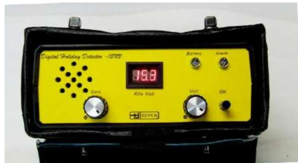
شمای دستگاههای با ابعاد کوچک (مینی) در رنج های 100 ولت و 1 کیلو ، 2 کیلو ، 5 کیلو، 10 کیلو و 15 کیلو ولت بهمراه شارژور اتوماتیک ، در فوق آمده است. از ویژگی دستگاههای دیجیتال در نمایش ولتاژ خروجی با دقّت 0.1 کیلو ولت میباشد
