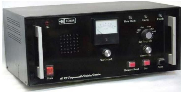
تغذیه دستگاه از برق 220 ولت بوده و لتاژ خروجی دی سی است . این دستگاه برای تعیین نقطه شکست عایق و نیز روغن ترانسفورماتور بکار گرفته میشود . با برنامه ریزی و تنظیمات اولیه از لحظه مقدار لتاژ ، روند بالا رفتن و لتاژ و.... دستگاه شروع بکار میکند ، بطور اتوماتیک و به آرامی و لتاژ بالا میرود ( طبق برنامه داده شده ) و بمحض شکست توانایی عایق ، جرقه زده شده و لتاژ در همان مقدار قفل میشود و ثابت میماند ، تا دوباره آزمایشی دیگر صورت پذیرد. دارای خروجی ( external Alarm ) میباشد
